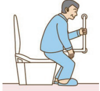
手すりをつける
